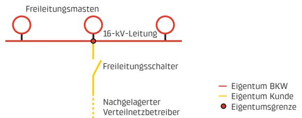
Die Eigentumsgränze befindet sich zwischen den Abgangsklemmen des Kunden und der Freileitung der BKW. Der Freileitungsschalter ist im Eigentum des Kunden.
