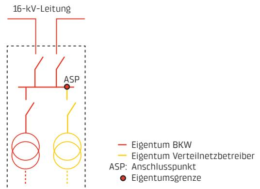
Die Eigentumsgränze befindet sich an der 16-kV-Sammelschiene vor dem Übergabefeld des Kunden. Bei Kompaktanlagen ist die Eigentumsgränze zwischen dem Trafobereich der BKW und dem Transformator des Kunden. Befinden sich in der Station ausschliesslich Transformatoren des
