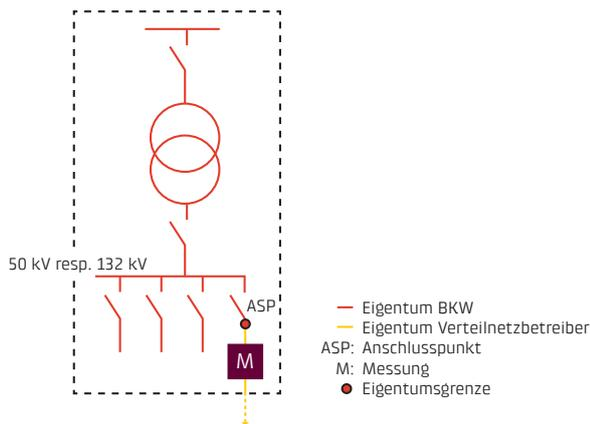
Die Eigentumsgrenze befindet sich in der BKW-Unterstation nach dem Abgangsfeld der BKW. Die Kabelendverschlüsse gehören zur Kundenanlage.
